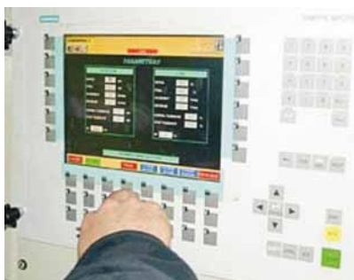
Sinhrozirani sustav podizanja digitalnom kontrolom prati radove
