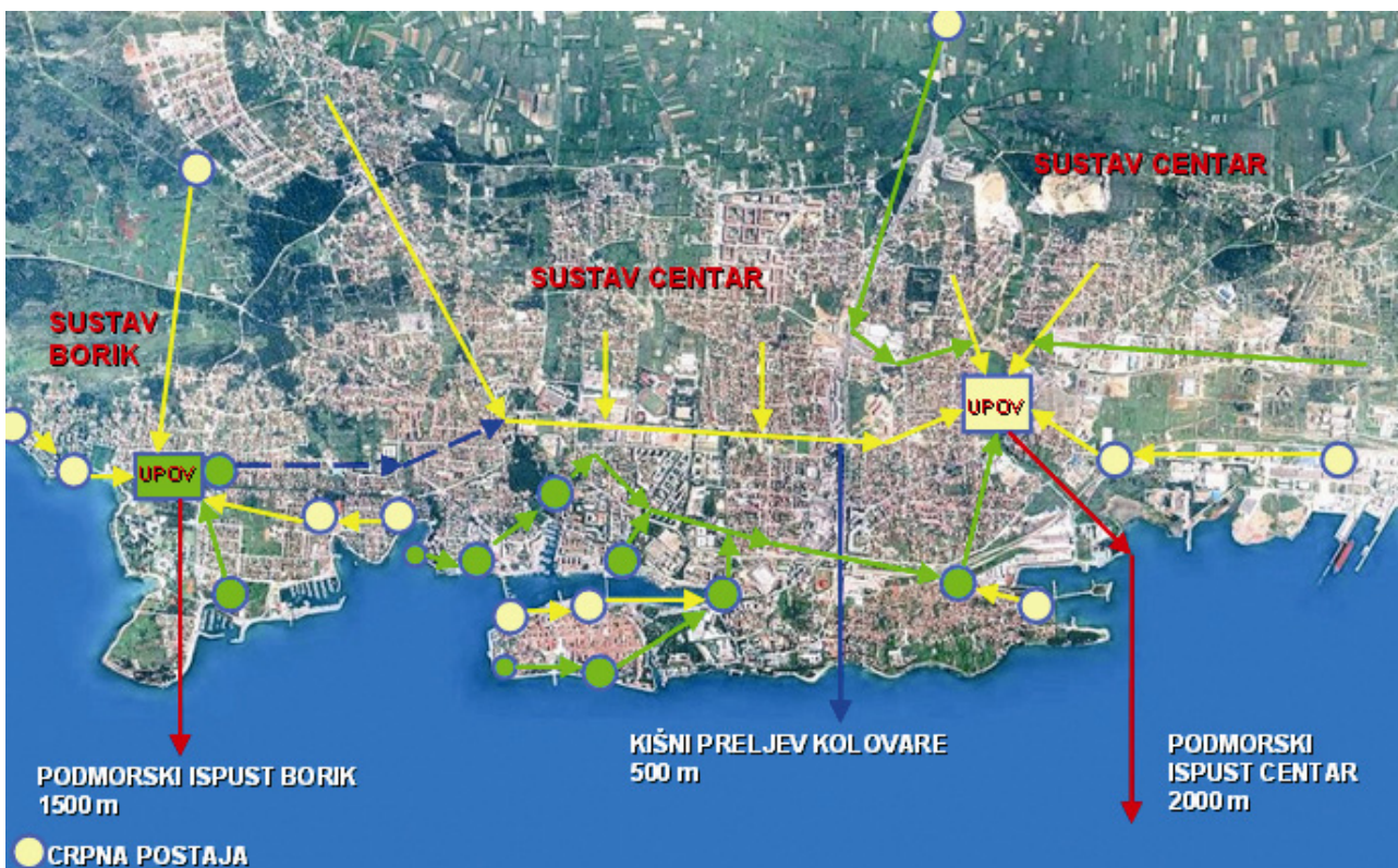
Shema planiranog kompletnog kanalizacijskog sustava Zadra
