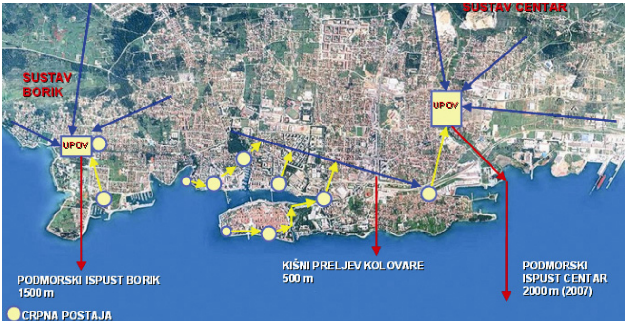
Shema sadašnjeg stanja kanalizacijskog sustava Zadra
