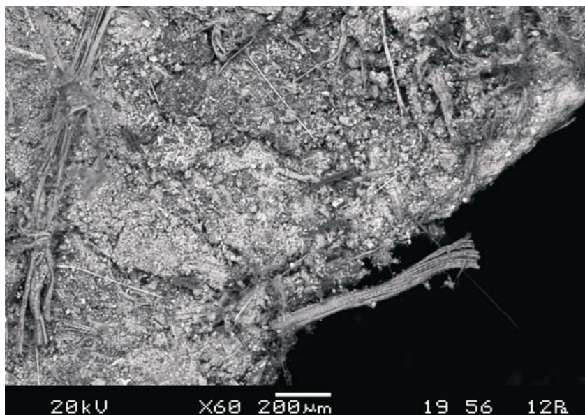
Mikrosnimka površine azbestcmentnoga pokrova
