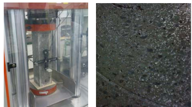
Slika 23. Ispitivanje statičkog modula elastičnosti pritiskom na preši (lijevo), vidljiva struktura betona vrlo visokih čvrstoća (desno)
