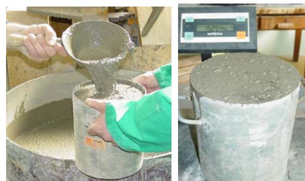
Slika 18. Određivanje specifične gustoće betona vrlo visokih čvrstoća
