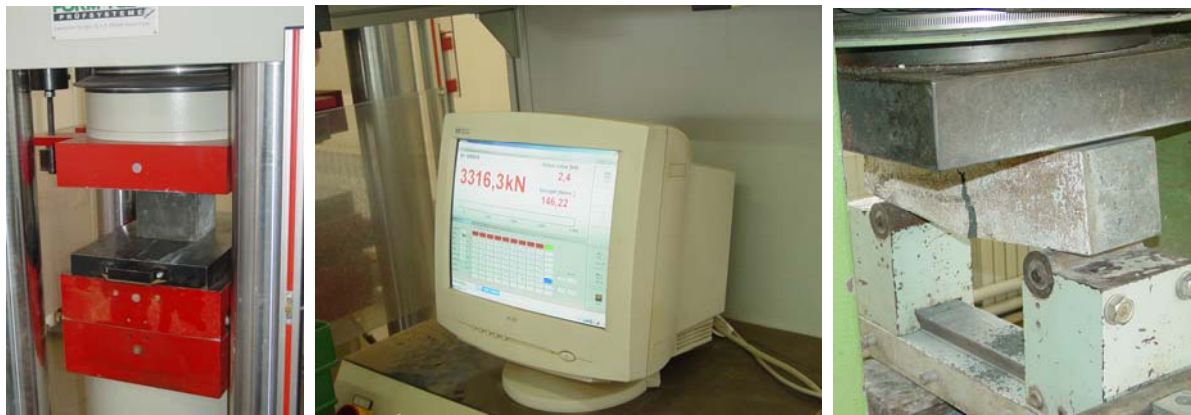
Slika 22. Ispitivanje tlačne čvrstoće (lijevo i sredina) i čvrstoće na savijanje (desno)
