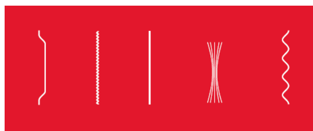
Slika 2. Osnovni oblici čeličnih vlakana (s kukicama, spiralna, ravna, zakrivljena, valovita)
