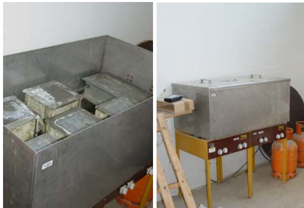
Slika 16. Postupak zaparivanja uzoraka betona vrlo visokih čvrstoća i praćenje temperature u zadanom vremenskom intervalu
