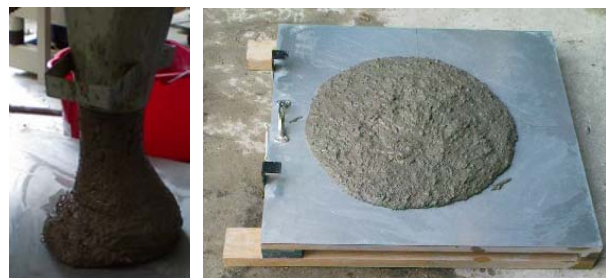
Slika 17. Rasprostiranje slijeganjem (metoda slump flow)
