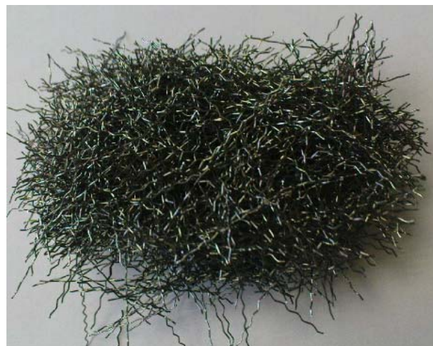
Slika 3. Medusobno upletanje valovitih čeličnih vlakana
