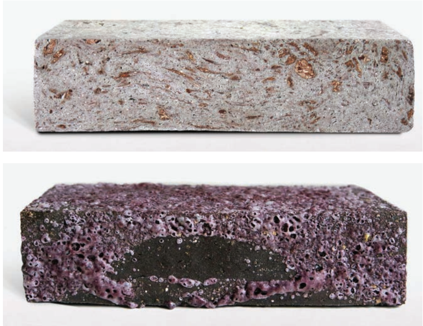
Prototipovi opeke ojačane usitnjenim kamenom i sličnim građevnim otpadom
