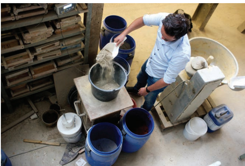
Zahvaljujući raznim dodacima, smjesa za opeke mijenja strukturu i dobiva raznolik kolorit
