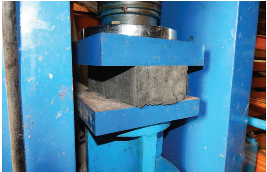
Ispitivanje primjerka eco-BLAC opeke u laboratoriju u Muzaffarnagaru
