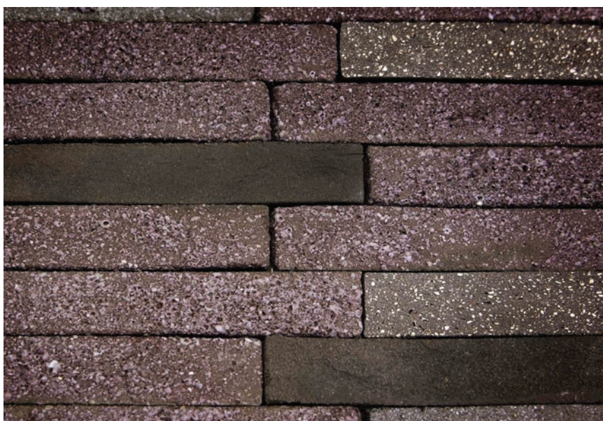
Zahvaljujući raznim dodacima, smjesa za opeke mijenja strukturu i dobiva raznolik kolorit (dolje), sasvim različit od onog tradicionalnog (gore)
