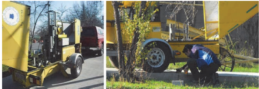
Slika 5. Ponavljanje opterećenja s FWD na slobodnom spoju [22]
