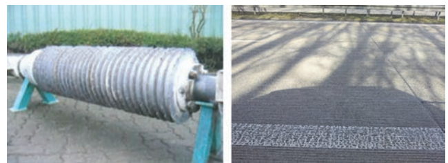
Slika 19. Žlijebljenje površine kolnika
