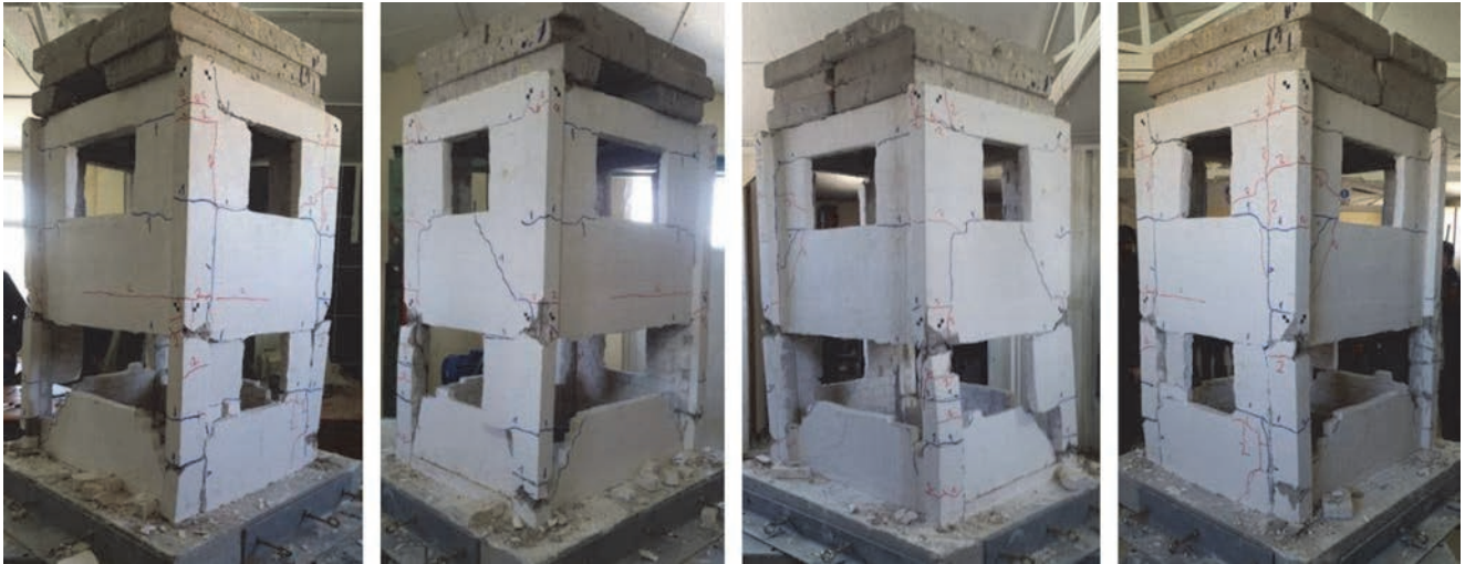
Slika 25. Način popuštanja uzorka 3 u drugoj fazi pomaka tla
