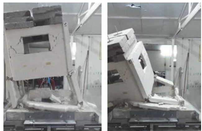
Slika 20. Način sloma uzorka 1 (0°)
