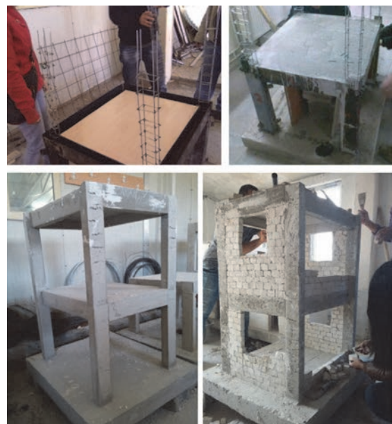
Slika 4. Etape gradnje uzorka
