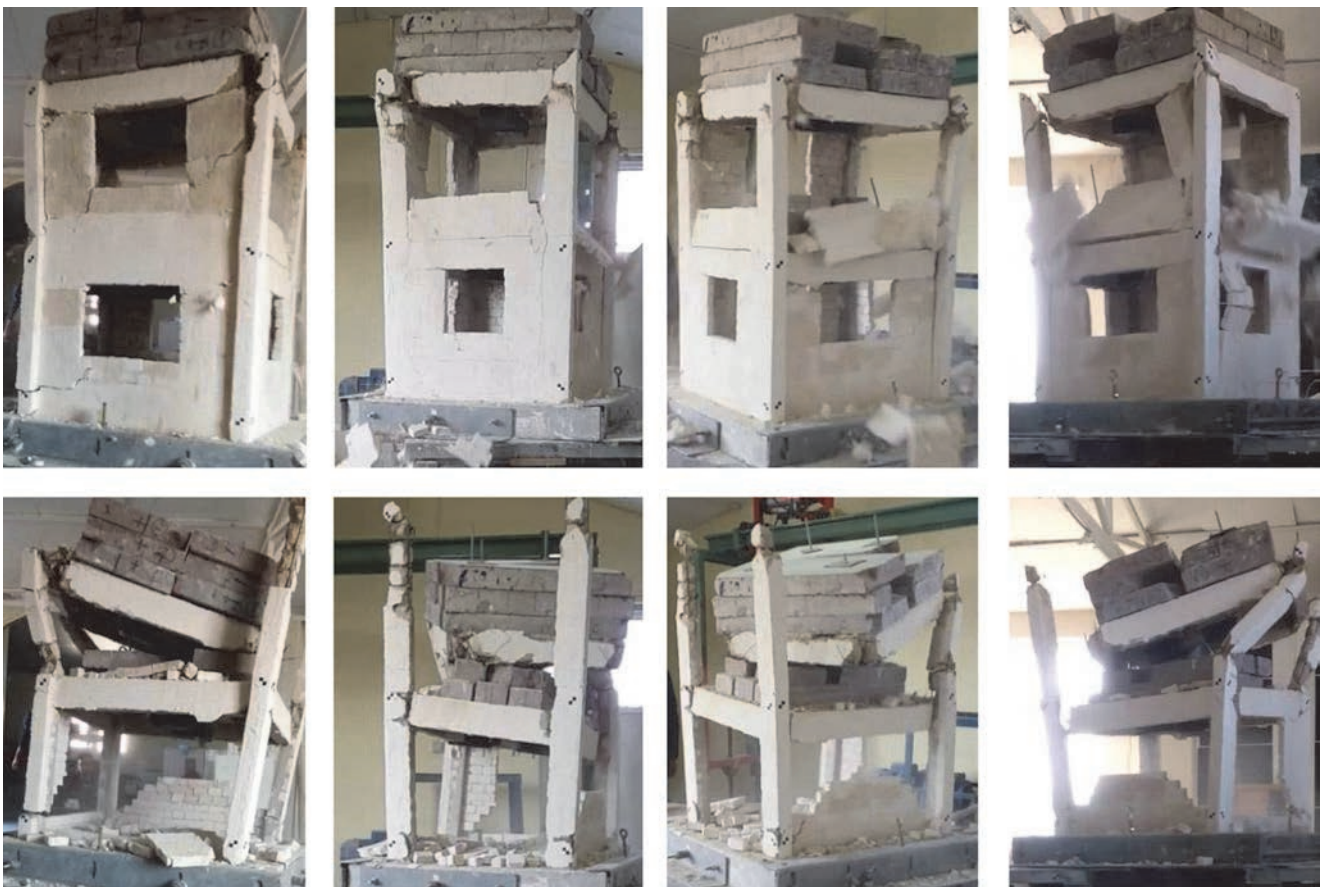
Slika 28. Način popuštanja uzorka 4
