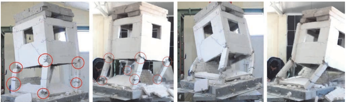
Slika 26. Način popuštanja uzorka 3 na kraju ponovljene prve faze pomaka tla
