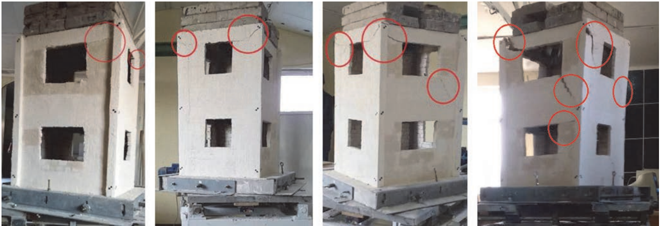
Slika 27. Pojava prvih pukotina na uzorku 4 (60°) u raznim smjerovima
