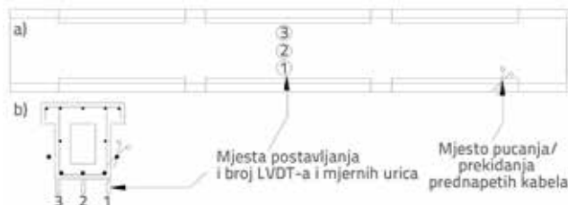
Slika 6. Položaj LVDT-a i mjerne urice: a) podgled; b) presjek
