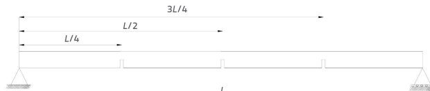
Slika 5. Mjesto pukotina na gredi
