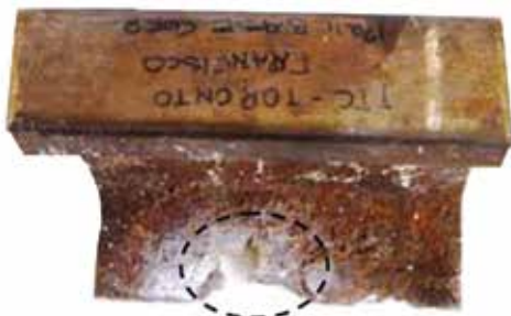
Slika 9. Ispitivani uzorak korodirane tračnice, gubitak materijala s bočne i gornje strane nožice tračnice; zaokružena mjesta predstavljaju mjesta koncentracije najvećih normalnih naprezanja [31]
