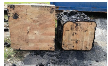
Tijekom požara stvara se sloj ugljena koji štiti podpovršinsko drvo od toplinskoga napada
