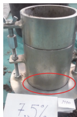
Slika 14. Curenje vode na dnu kalupa tijekom procesa zbijanja
