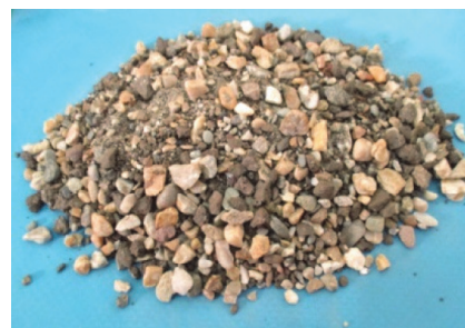
Slika 7. Mješavina koja sadržava prirodni agregat i RAP sa sljedećim udjelom sastava: 70 %SG : 30 %RAP
