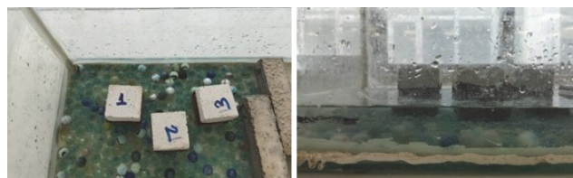
Slika 8. Priprema za ispitivanje sorptivnosti
