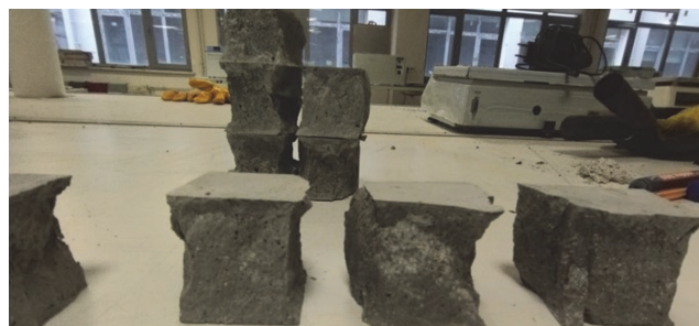
Slika 16. Uzorci za ispitivanje tlačne čvrstoće nakon ciklusa smrzavanja-odmrzavanja
