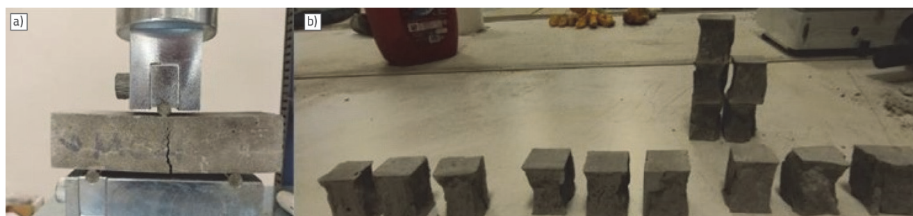
Slika 5. a) Prizme pripremljene za ispitivanje čvrstoće na savijanje; b) Slomljene prizme nakon ispitivanja
