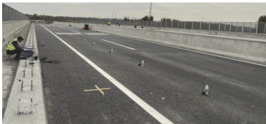
Slika 10. Terenska fotografija određivanja dinamičkih parametara mosta
