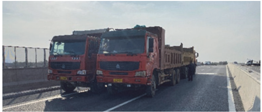
Slika 5. Faza statičkog ispitivanja mosta s 4 kamiona
