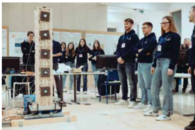
Natjecanje studenata građevinskih fakulteta - testiranje modela zgrada na potres simuliran miniplatformom
