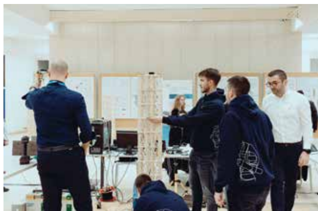
Natjecanje studenata građevinskih fakulteta - testiranje modela zgrada na potres simuliran miniplatformom
