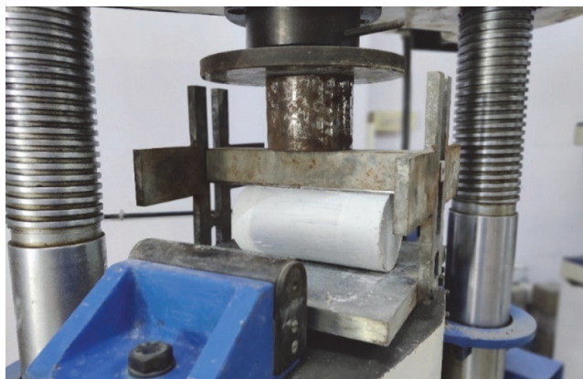
Slika 5. Uređaj za ispitivanje vlačne čvrstoće cijepanjem
