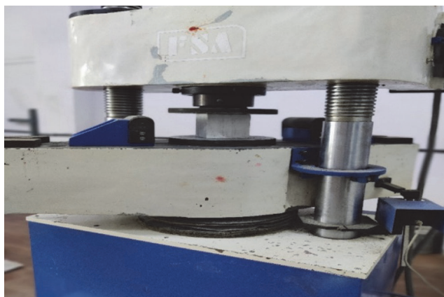
Slika 4. Uređaj za ispitivanje tlačne čvrstoće
