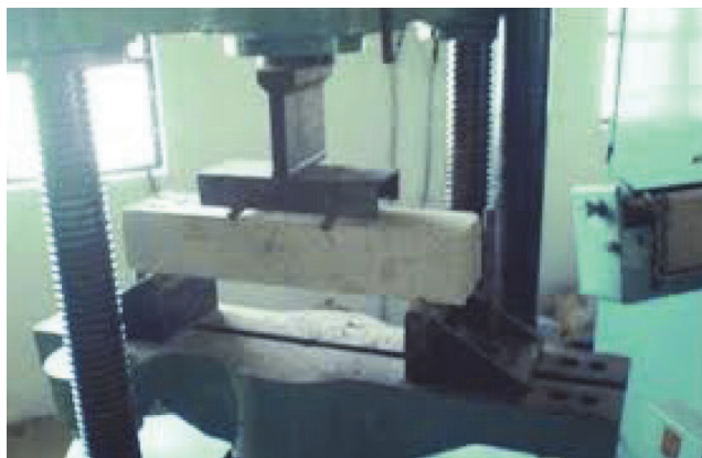
Slika 6. Uređaj za ispitivanje čvrstoće na savijanje
