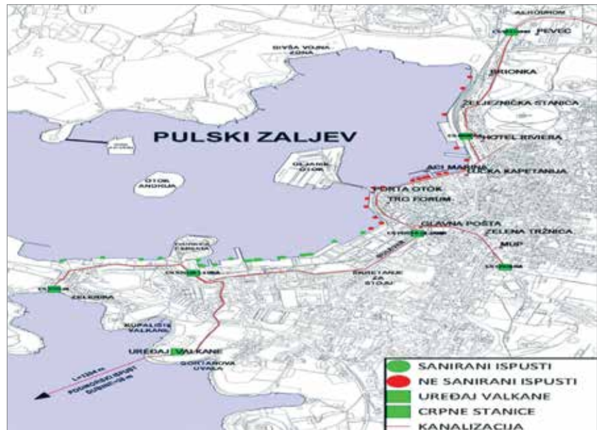
Trasa glavnoga obalnog kolektora s ispustima u more
